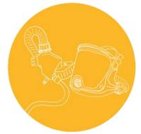
Frischlucht-Druckschlauchgerät / Druckluft-Schlauchgerät
