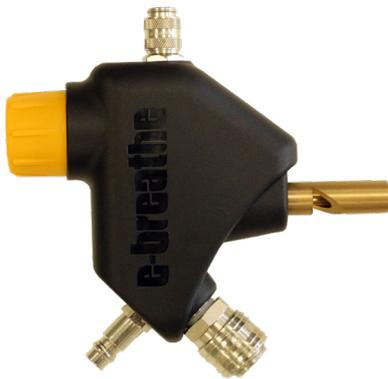
Das **e-Line** Druckluft Regelventil wird am Gürtel getragen und bildet in Kombination mit einem e-breathe Kopfteil oder Anzug ein druckluftunterstütztes Atemschutzsystem mit kontinuierlichem Luftstrom. Das System schützt den Anwender vor Schadstoffen wie Partikel, Staub, Dunst (Aerosole), Gase oder Dämpfe und ist als umgebungsluftunabhängiges Gerät auch in Umgebungen einsetzbar, in denen der Einsatz von filtrierendem Atemschutz nicht möglich wäre.
